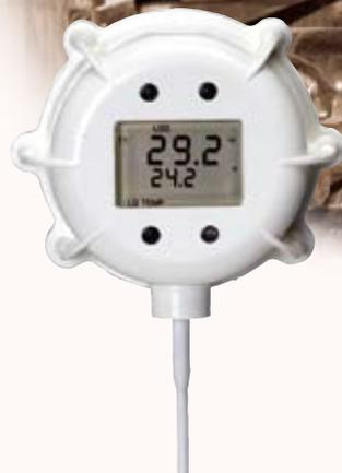
Estos registradores de temperaturas, impermeables y compactos disponen de una pantalla, por lo que se pueden controlar las temperaturas sin tener que transferirlas a un PC hasta que sea necesario. Acumulan hasta 16000 datos de temperatura en un intervalo programable entre el segundo y el día.
