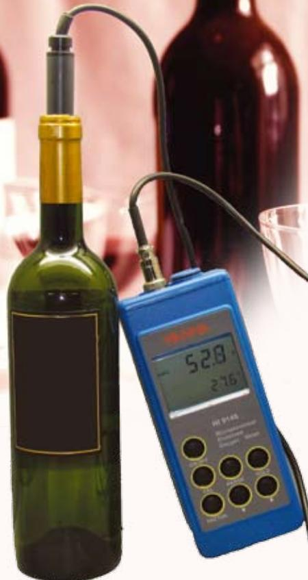
HI 9146V permite medir el oxígeno disuelto en el vino tanto en tanques como en botella. El instrumento, dotado de las funciones de compensación automática de temperatura, altitud y salinidad, está aconsejado para quienes efectúan tratamientos de micro-oxigenación y en general a quienes efectúan controles de de O<sub>2</sub> durante todo el proceso productivo.
